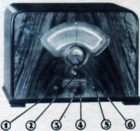
1 Korrektur für Kurzwelleneinstellung. - 2 Abstimmung. - 3 Tonblende - 4 Wellen- und Tonabnehmerhalter - 5 Netzhalter und Lautstärke-regler. - 6. Abstimmanzeiger.
